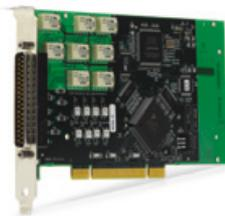
NI PCI-6520 工业数字 I/O 卡, 具有最大切换功率达 60W 的 8 路  $\pm 60$  VAC 或 30 Vrms 的继电器输出通道, 以及 8 路通道间隔离和工业标准 24V 逻辑电平的  $\pm 30$  VDC 数字输入通道。其数字输入可连接漏极和源极两种信号。NI PCI-6520 具有看门狗定时器, 可对各种计算机和应用程序进行故障修复, 令其可靠性更佳。同时, 其可编程上电状态、数字滤波器和变动检测可对您的应用程序实施最优化控制。PCI-6520 具有可连接各种低价位附件的标准 37 针 D-Sub 连接器, 您还可使用 NI-DAQmx 测量服务软件, 令设置更为高效快捷。
