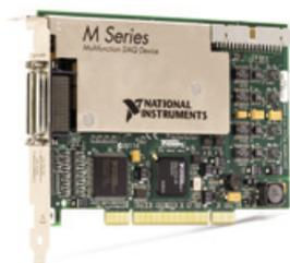
PCI 总线是当今使用最为广泛的内部计算机总线之一。PCI 总线提供了高速的传输，理论带宽的速度可达 1056 Mbits/s，为需要高速数据流应用的客户提供了便利。NI 针对 PCI 总线提供了多功能的数据采集设备，最新推出的 M 系列 DAQ 产品是 NI 新一代的多功能数据采集设备。M 系列产品的新技术包括 NI-STC 2 系统控制器、NI-PGIA 2 放大器和 NI-MCal 校准技术，这些技术可以提供更高的性能、精度和更多的 I/O，而且价格甚至比 E 系列产品还低。由于 M 系列 DAQ 设备引进多种新技术和特性，可广泛适用于测试、控制和设计应用中，包括自动化测试、过程控制，原型验证以及传感器测量等。
