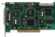
PCI-6533 (DIO-32HS) 是用于 PCI 的高速 32 位并行数字 I/O 接口。PCI-6533 包括 NI DAQ-DIO ASIC, 一个专为高性能插入式数字 I/O 板卡设计的 32 位通用数字 I/O 接口。本设备能进行单点 I/O、模式 I/O 和速度高达 76 MB/s、使用多种握手协议的高速数据传输。
