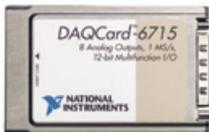
NI DAQCard-6715 是 12 位高速模拟输出的 PCMCIA 数据采集卡。您能同时在 8 条模拟输出通道上获得每条通道高达 1 MS/s 的速率。此外 NI DAQCard-6715 有 8 条数字 I/O 线和 2 个 24 位 20 MHz 的计数器 / 定时器及数字触发。
