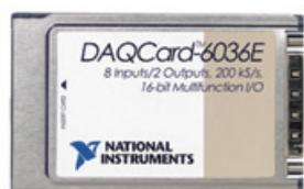
PCMCIA (PC 卡) 的小巧体积和轻质的重量使得他们对于使用笔记本的便携式应用十分完美。并且，PCMCIA (PC 卡) 支持热插拔，安装十分简单，传输速率高达 20 Mbits/s。NI 为您提供各种应用于高速模拟和数字 I/O、精度 16 位以及低价位测量的 PCMCIA 总线数据采集卡。经由 NI ASIC 创新设计，NI PCMCIA DAQCard 数据采集产品能以更轻巧的工具包提供全面的 DAQ 高级功能和技术。大量 DAQCard 产品由于其出色的便携性，可与 LabVIEW PDA 模块一起运用于掌上计算机。
